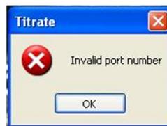
Figura 10. Instalación o configuración incorrecta del puerto de comunicaciones.
