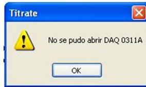
Figura 9. Instalación incorrecta de la tarjeta Futek DAQ-0311.
