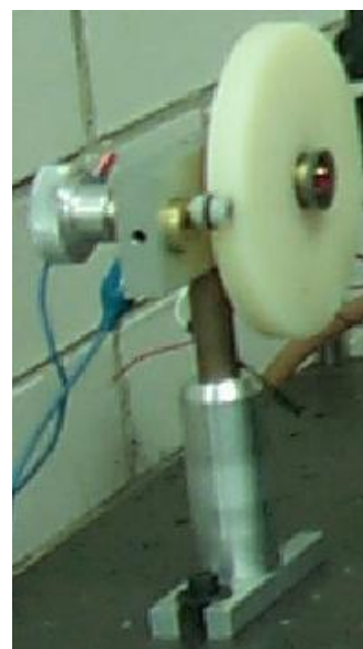
Figura 9. Esquema y fotografía del arreglo de engranes que permiten girar el ángulo de polarización y balancear el puente óptico.
