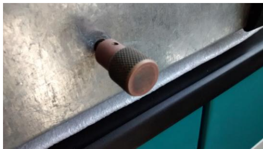
Figura 8. Manivela que controla el desplazamiento de la Platina longitudinal.
