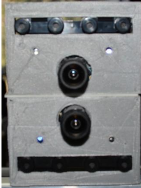
Figura 7. Arreglo de un par de cámaras para la obtención del mapa de profundidad. Para reducir la distancia entre las cámaras una de ellas se gira 180°.
