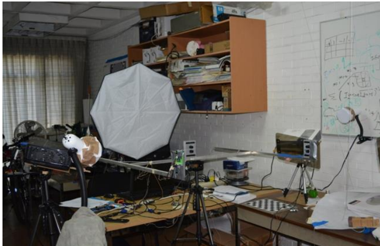
Figura 12. Sistema de estéreo visión múltiple junto a la iluminación externa utilizada.
