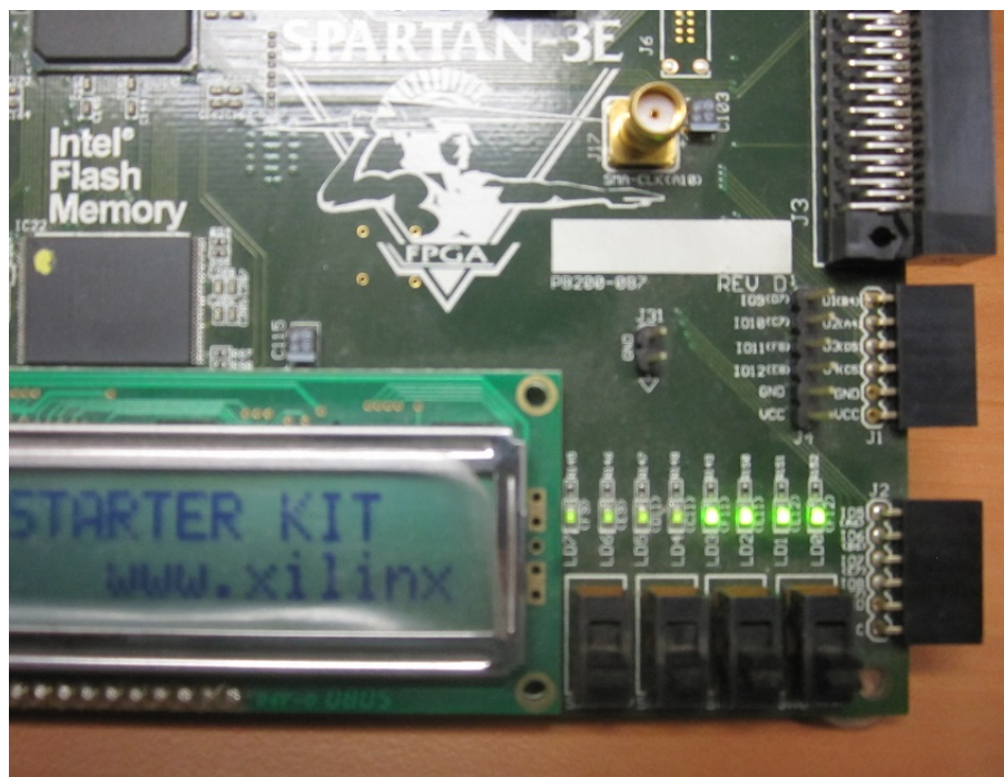
Figura 4. Ejemplo del control de intensidad de los LEDs con un módulo PWM.
