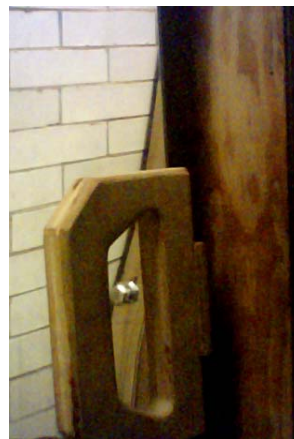
Figura 7. Esquema y fotografía de las asa utilizadas para deformar al espejo.
