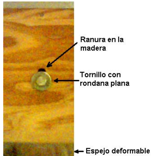
Figura 8. Tornillo deslizante y ranura que lo alberga.
