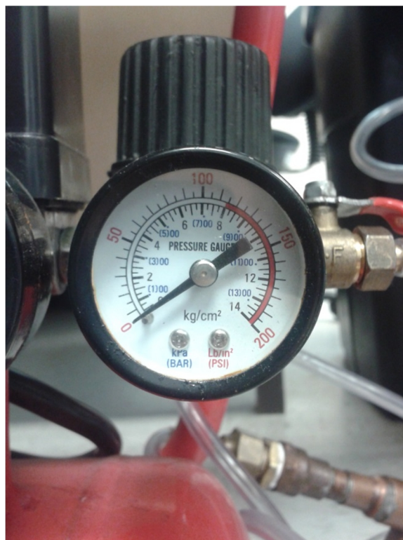
Figura 38. Manómetro de referencia usado para calibración.
