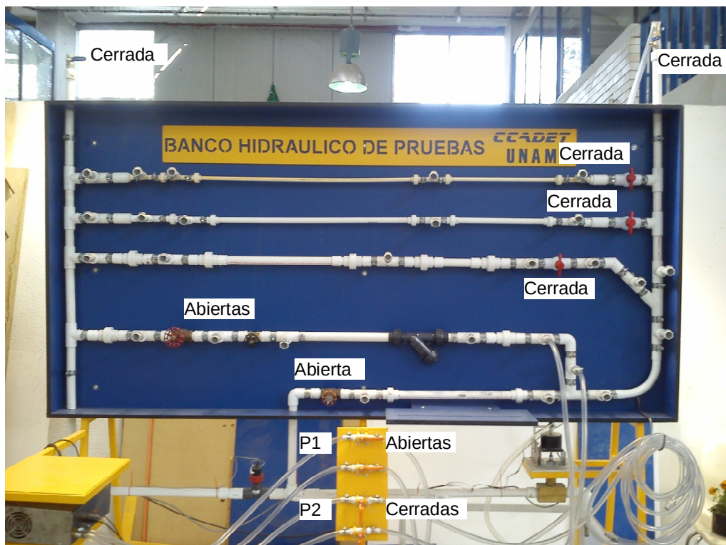
Figura C.3. Diagrama de conexiones para medir la caída de presión en el codo 90° de PVC de ½”.
