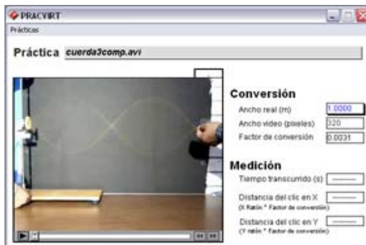
Figura 60. Experimento basado en video de ondas estacionarias en una cuerda con otras condiciones.
