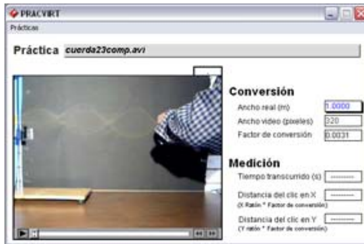
Figura 59. Experimento basado en video de ondas estacionarias en una cuerda realizada por los profesores.
