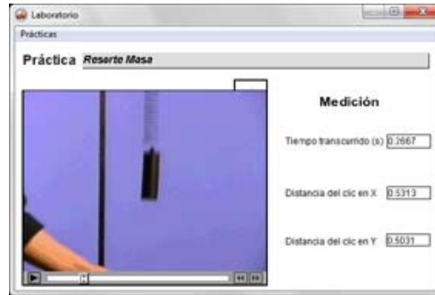
Figura 50. Imagen del experimento resorte-masa montado en el LVB.
