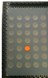
Figura 14. Encendido del led columna 3 fila 5 de la matriz de 5x7.
