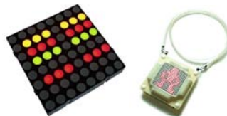
Figura 15. Matriz de 8x8 RGB y una aplicación directa el Bitman desarrollado por Ryota Kuwakubo.
