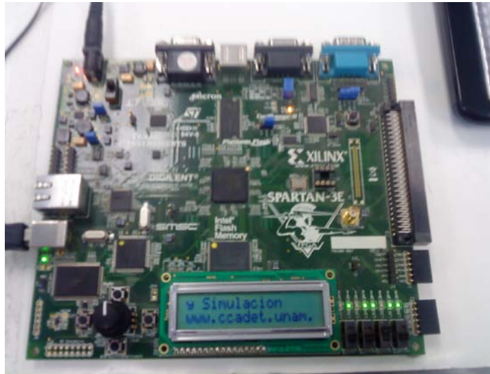
Figura 3. Tarjeta de desarrollo Spartan-3E fabricada por la empresa Xilinx.
