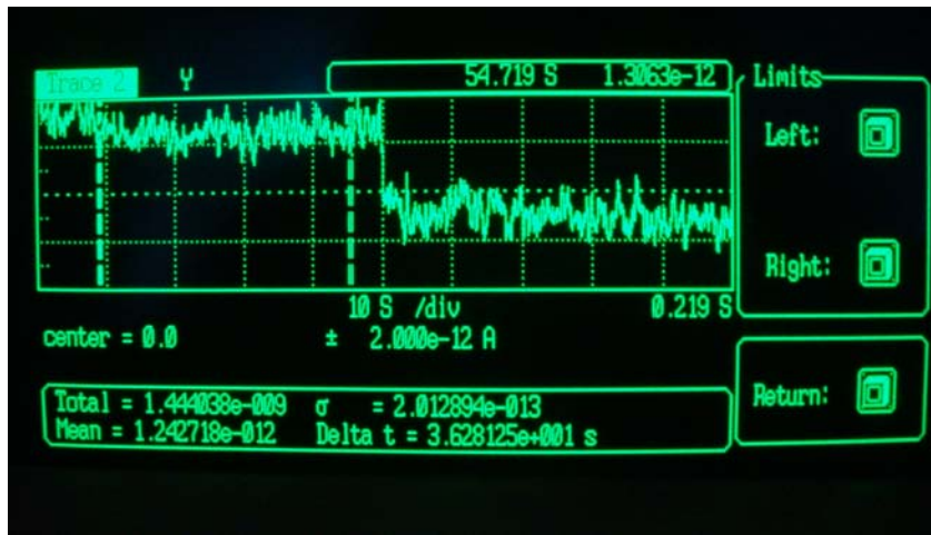
Figura 12. Señales de corrientes \Delta I_s y \Delta I_{cal} registradas por el amplificador lock-in para calcular la mínima resolución \Delta I_{am} que se detectó con el arreglo experimental del sistema de medición.
