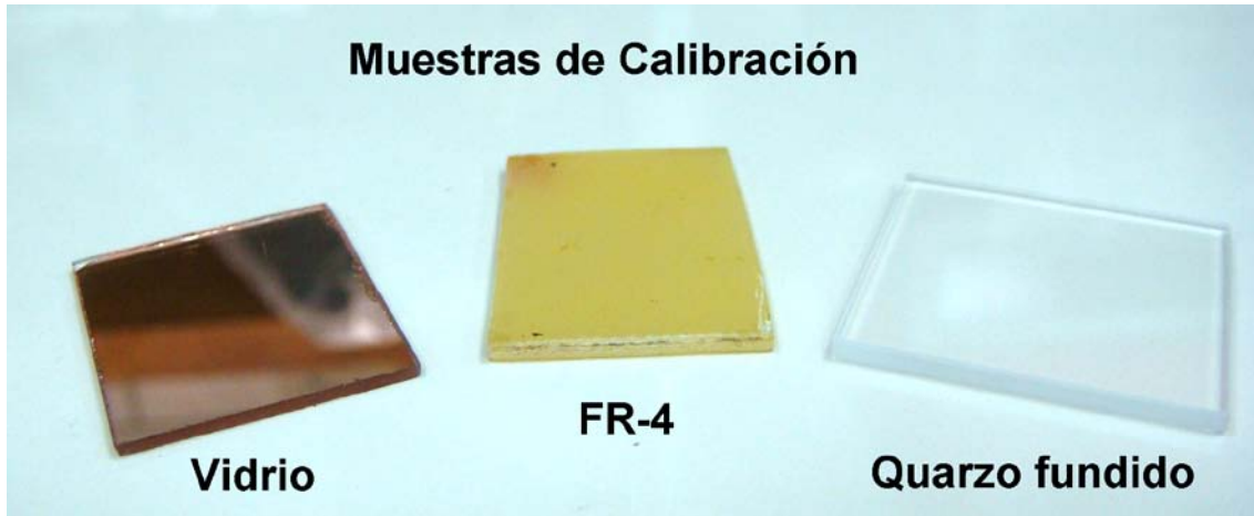
Figura 13. Muestras de calibración utilizadas en las mediciones capacitivas. El vidrio tiene una película de cobre en una de sus superficies.
