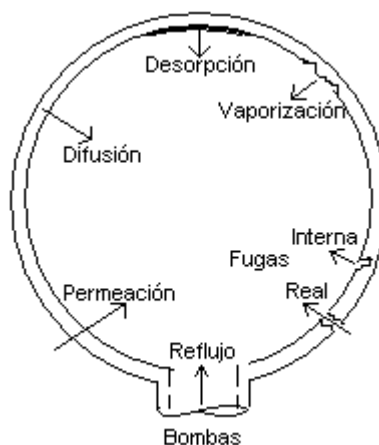
Figura 1. Fuentes potenciales de gases y vapores en el sistema de vacío.
