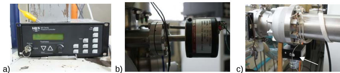
Figura 9. a) Controlador de presión MKS 651C, b) medidor de presión MKS Baratrón 122A y c) válvula rotatoria.
