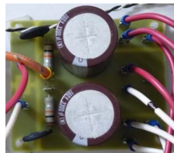
Figura 28. Sistema electrónico para la fuente bipolar.
