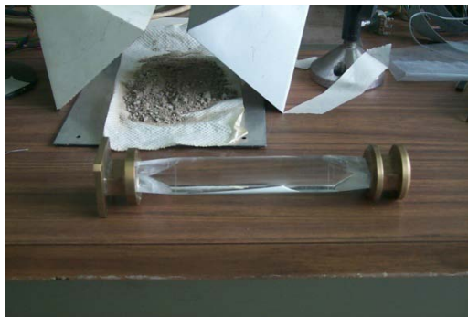
Figura.3 Se aprecia en primer plano el maquinado inicial de un material sólido para ser insertado en la línea de transmisión.
