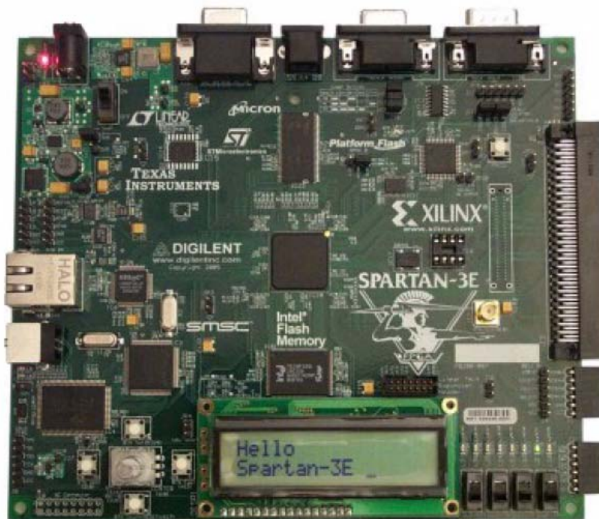
Figura 1. Tarjeta de desarrollo Spartan-3E Starter Kit Board .
