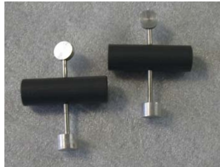
Figura 5. Electrodo puntuales de los graficadores: izq.) Acero inoxidable, der.) Aluminio
