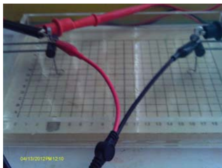
Figura 10. Arreglo de electrodos puntuales en configuración del dipolo.
