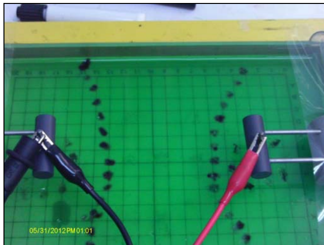
Figura 41. Líneas equipotenciales de un dipolo en carragenina comercial Ya'sta y electrodos de Hierro.
