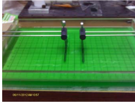
Figura 11. Arreglo de electrodos lineales en configuración de placas paralelas.
