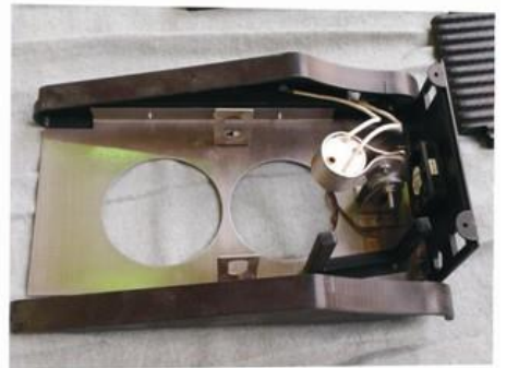
Armado de piezas laterales de ABS y base de lamina y aditamentos cortados en la Water jet
