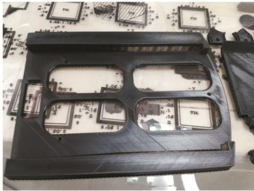
Base de ABS en substitución de la placa de aluminio de 1/4"
