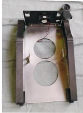
Armado de piezas laterales de ABS y base de lamina y aditamentos cortados en la Water jet
