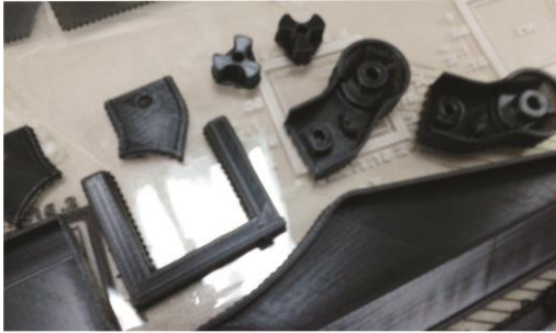
Piezas del mecanismo parte de la pieza lateral y la pieza en C para colocación del circuito impreso en ABS.
