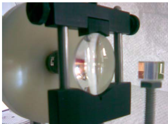
Figura 1.7. Componentes del sistema, de derecha a izquierda: cubo divisor de haz, lente convergente y al fondo sistema con polarizador y LED.
