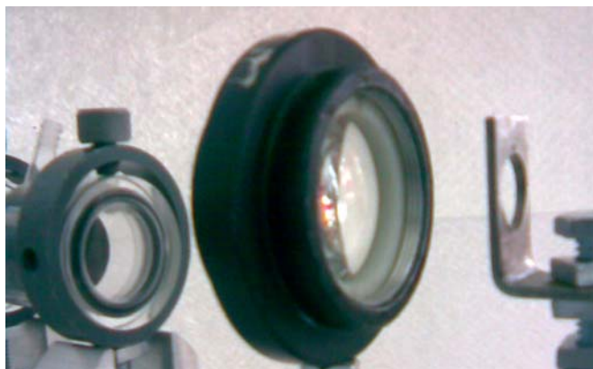
Figura 1.9. Componentes del sistema, de Izquierda a derecha: cámara, lente convergente y soporte del detector de medición.
