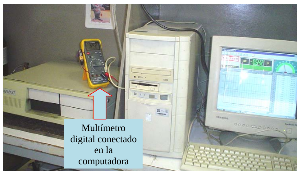
Figura 1.15. Vista externa del sistema mientras se realiza una prueba de detección de gases.
