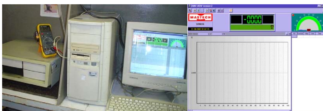
Figura 3.9. Aspecto exterior del sistema al realizarse una prueba y la ventana del software que nos permite la adquisición de los datos.
