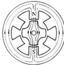
Figura 4. Circuito magnético en un motor de pasos de reluctancia variable.
