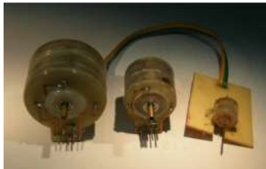
Figura 69. Motores de pasos basados en el principio de fuerza de Lorentz.
