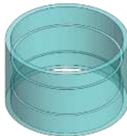
Figura 54. Carcasa del motor a pasos basado en fuerza de Lorentz.
