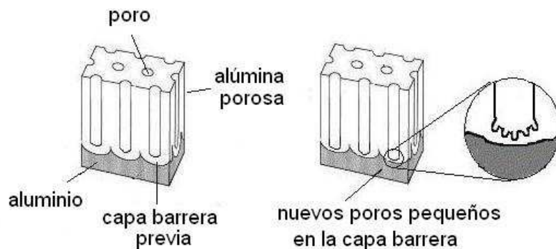
Figura 5. Capa barrera adelgazada por reducción de voltaje
