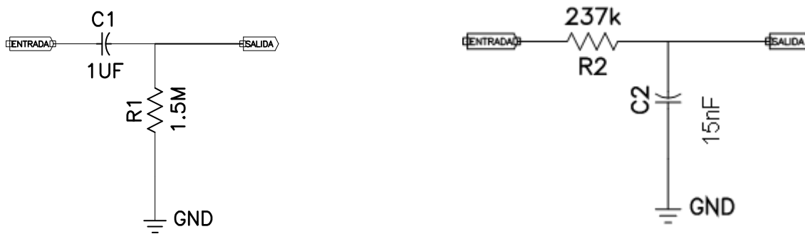
Figura 48. Filtros paso altas y paso bajas para señales de EEG
