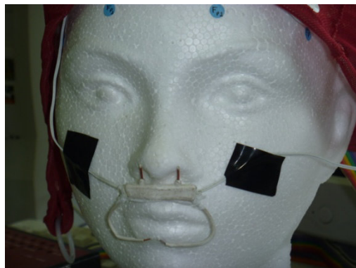
Figura 3. Forma de colocar en el paciente el sensor de flujo respiratorio.
