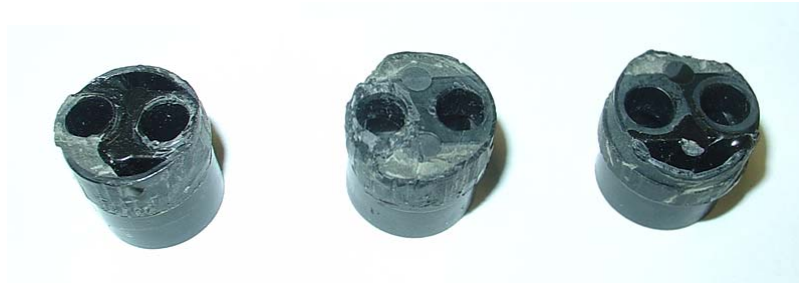
Figura 6. Cabezales recuperados para el montaje de los lentes, donde se observa el daño en la base.
